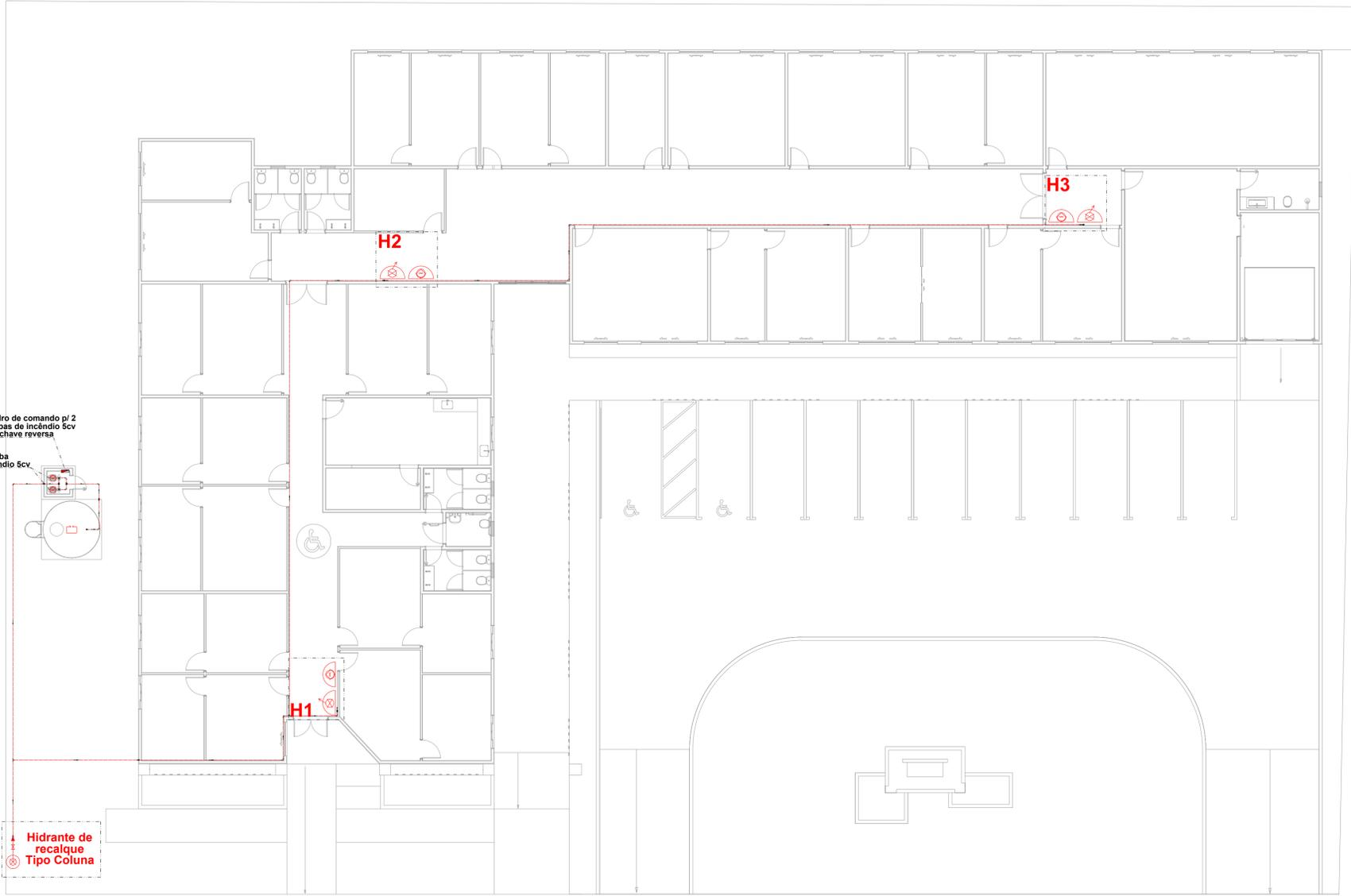
Quadro de comando p/ 2 Bombas de incêndio 5cv com chave reversa
