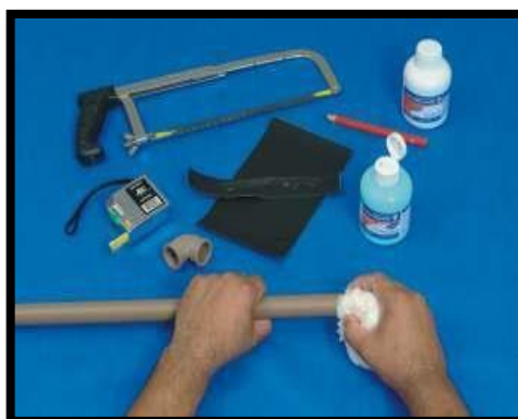
Figura 6. Execução da Tubulação Soldável
