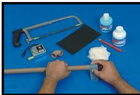
Figura 5. Execução da Tubulação Soldável
