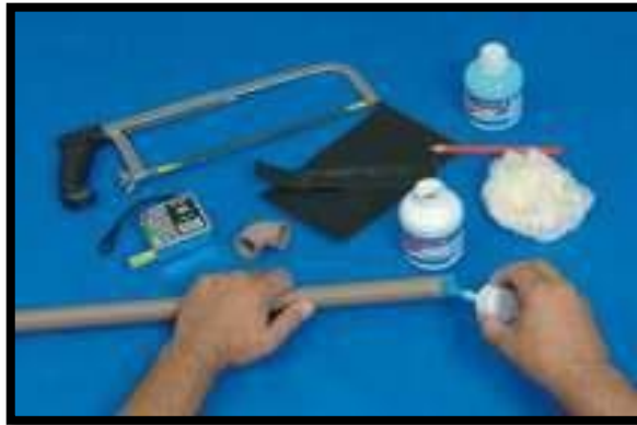
Figura 7. Execução da Tubulação Soldável
